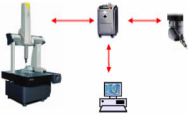
图1 三坐标测量机组成
