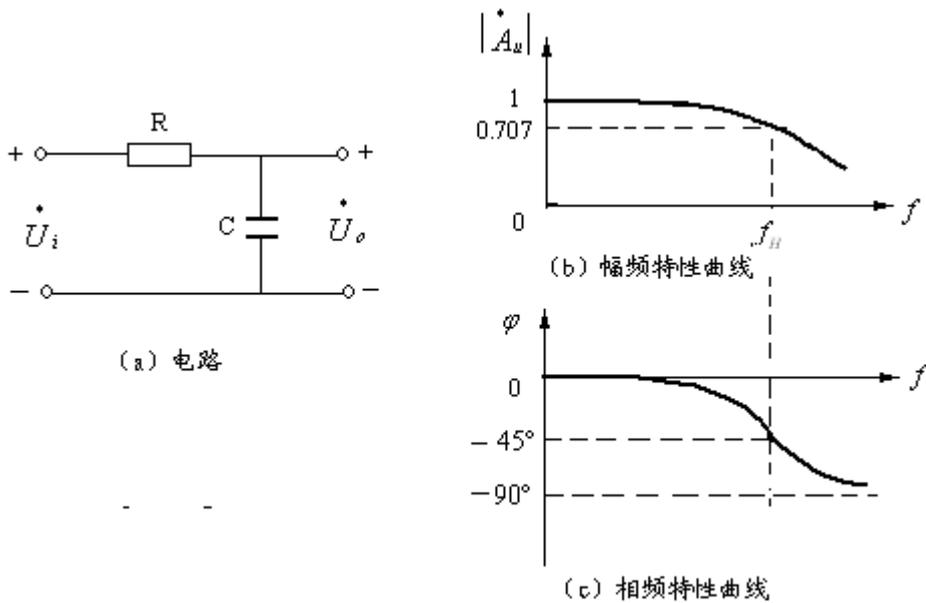
图 1 简单 RC 低通滤波电路
