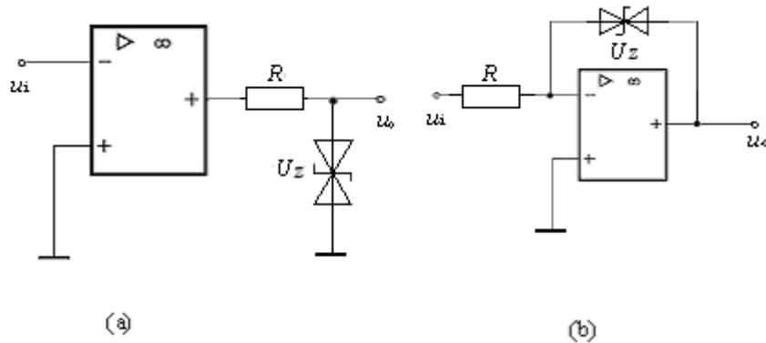
图 8 带稳压管的过零电压比较器
