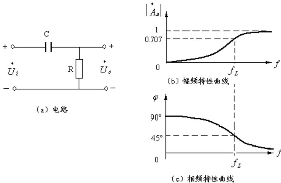
图 2 简单 RC 高通滤波电路
