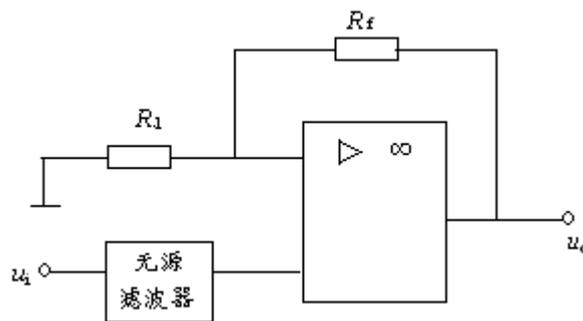
图 3 用集成运放构成的有源滤波器
