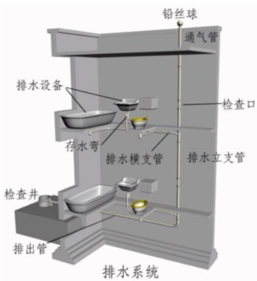
建筑内部污废水排水管道系统由污(废)水受水器、排水管道、通气管、清通装置和提升设备组成, 按排水立管和通气立管的设置情况分为3种方式:
