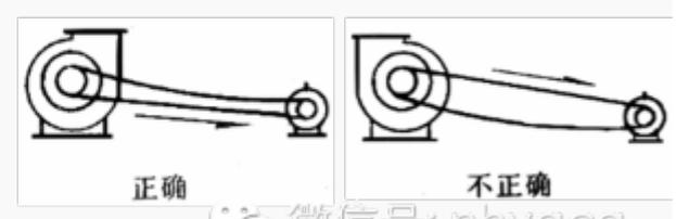
皮带正确连接方式
