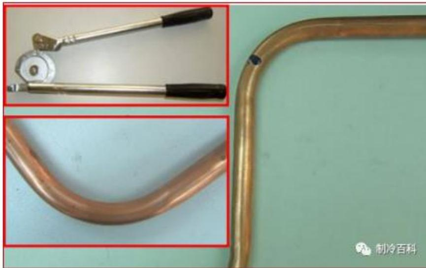
使用合适的弯管器；冷媒管的弯管外表面应无折皱；弯管角度不可超过 90 度；
