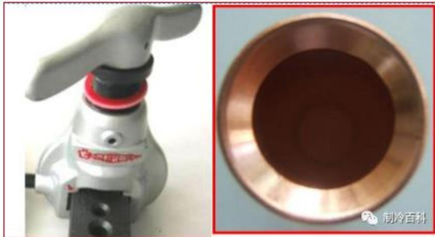
使用合适的扩口器；冷媒管切割面应锉平，去除内、外毛刺；扩口内表面光洁无伤痕；
