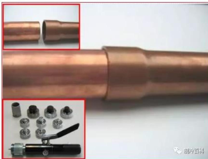
使用合适的胀管器；冷媒管切割面应锉平，去除内、外毛刺；冷媒管套接应紧密；焊接时冷媒管外表面应清洁；
