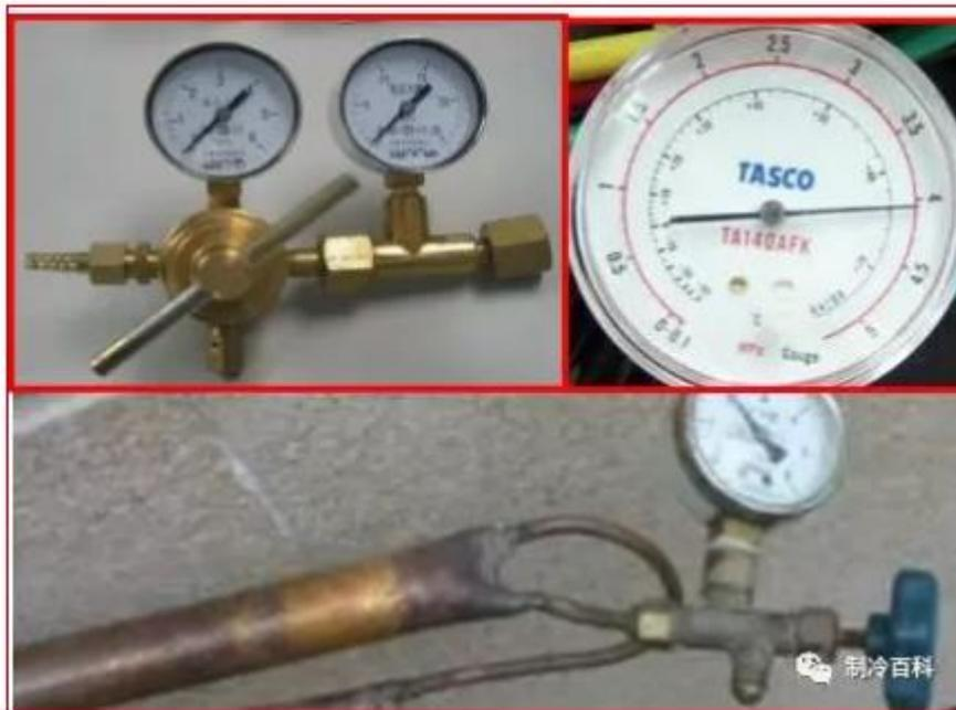
试压介质一定要使用氮气； 试压压力为 4.0Mpa(40kgf/cm<sup>2</sup>)。不可超过 4.0Mpa(40kgf/cm<sup>2</sup>)，保持 24 小时以上无泄漏为符合；采用液管、气管双管同时试压；
