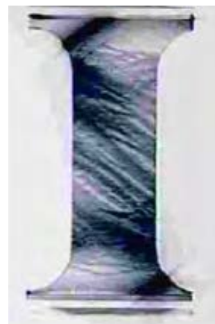
低碳钢拉伸样中的滑移带
