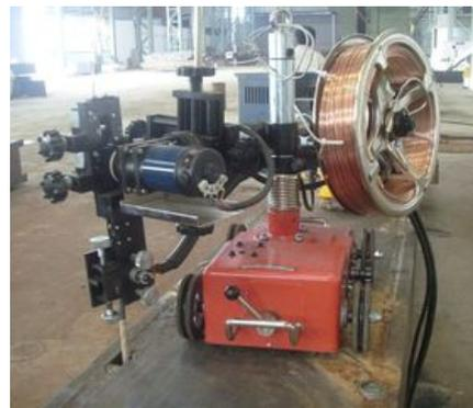
(b) 熔嘴电渣焊机
