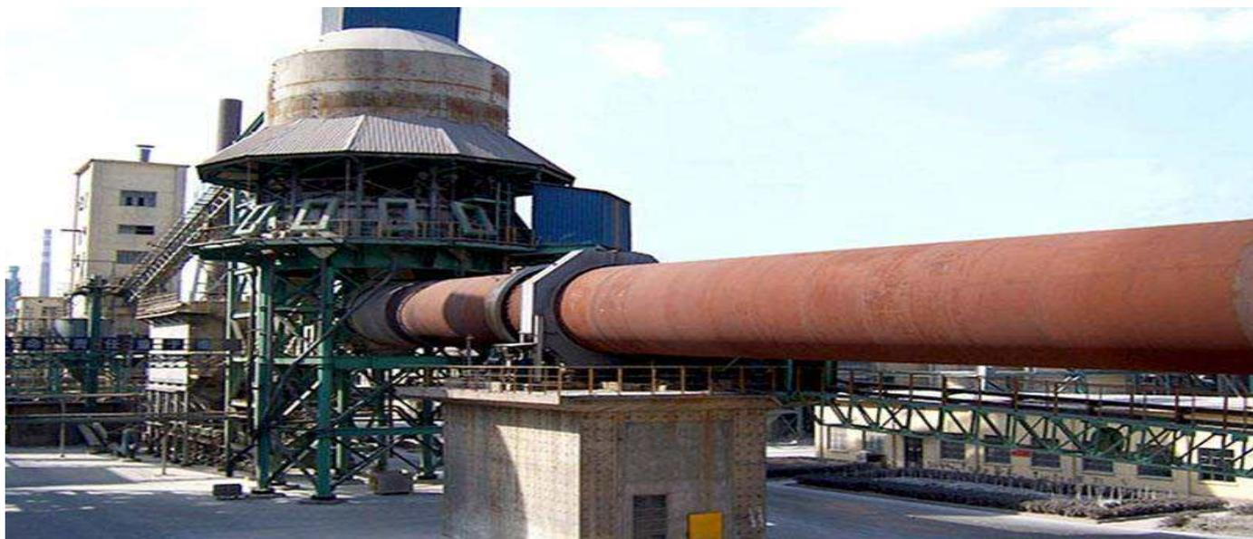
**工作过程：**矿石从炉体一端由圆盘给矿机给入溜槽，送至炉子的加热区。矿石在炉内与热气流逆向运动，在加热区将矿石加热到还原温度。为了使气流和矿石充分接触，炉内装有搅拌叶片。加热后的矿石进入反应带，与还原煤气接触，完成还原反应。反应产物进入冷却带与进入的煤气相遇，煤气受到预热，而还原产物被冷却，最后排除炉外（此时产物温度约为50-70℃）。矿石在炉内停留时间一般为2-4h。
