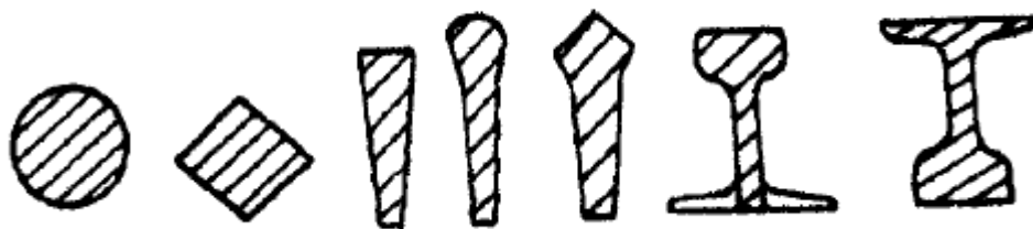
常用的不同棒条的断面形状
