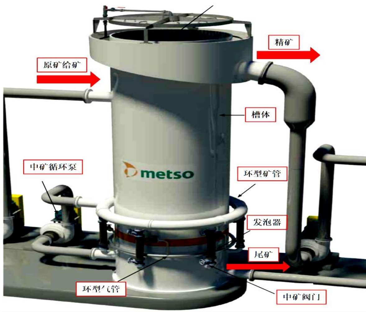
Microcel浮选柱结构示意图
