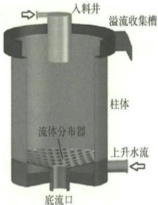
分选的加工过程是：煤粒通过水流变成液态固态混合物，受到不同煤粒密度上的差异会产生不同的干扰层。当床层运动稳定时，煤粒密度未能达到干扰层密度的细粒会上浮到溢流面，密度较高的颗粒会沉入底液，最终实现分选目的。
