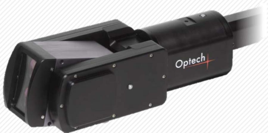
三维激光扫描技术是集光、机、电和计算机于一体的非接触测量技术，具有测量速度快、自动化程度高、分辨率高、可靠性高和相对精度高的特点，其扫描结果直接显示为点云，利用点云数据，可快速建立结构复杂、不规则的场景的三维可视化模型，既省时又省力，其三维激光扫描头如左图所示。
