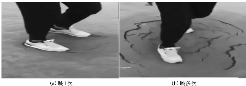
图 1-23 砂土地基液化
