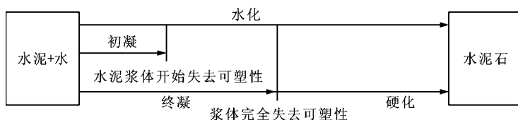
图3-4 水泥的水化、凝结与硬化示意图
