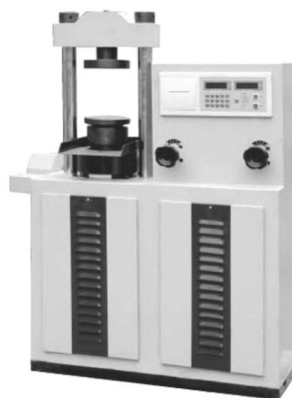
图 3-19 抗压强度试验机
