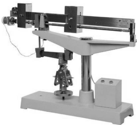
图 3-18 抗折强度试验机
