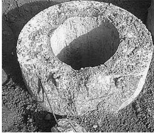
图 3-12 桩顶碎裂
