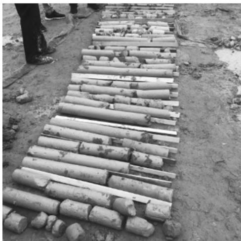
图 3-10 钻芯取样后灌注桩出现断桩
