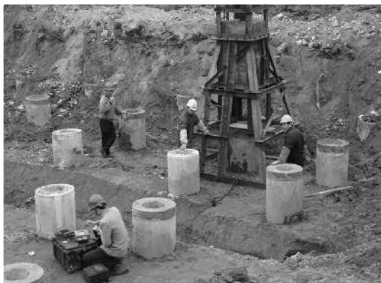
图 2-33 桩基动测试验
