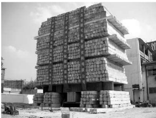
图 2-32 桩基静载试验
