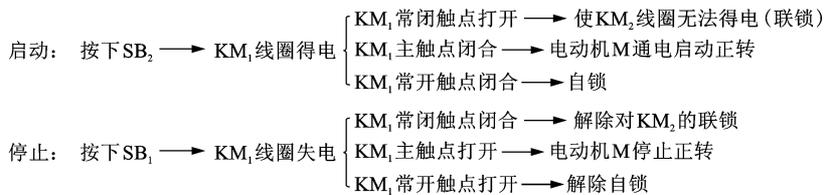
图 5-12 正转启停控制顺序图
