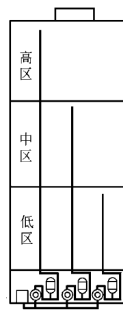
图 2-13 气压罐给水方式
