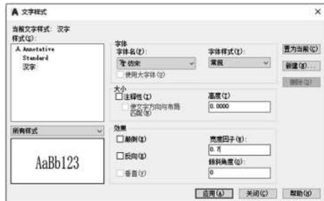
图 1-81 “文字样式”对话框中的各项设置
