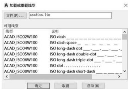
图 3-5 “加载或重载线型”对话框
