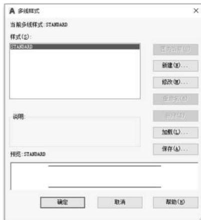
图 1-21 “多线样式”对话框
