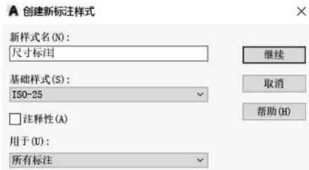
图 3-14 “创建新标注样式”对话框
