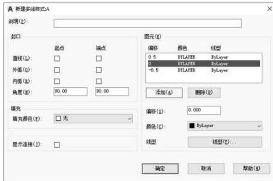
图 1-23 “新建多线样式”对话框
