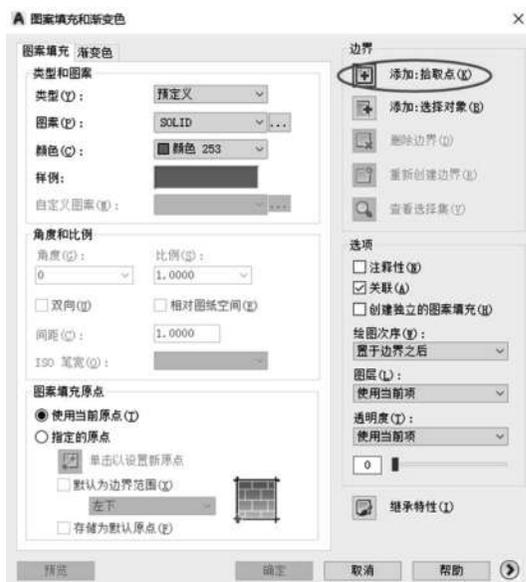
图 3-31 “图案填充和渐变色”对话框
