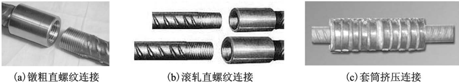
图 2 - 23 钢筋机械连接接头
