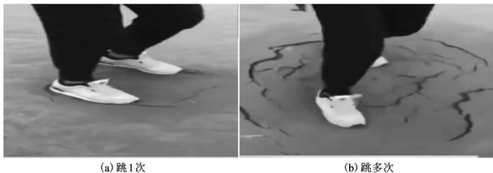
图 1-23 砂土地基液化
