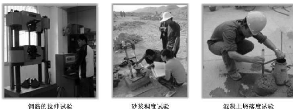
图 2-4 施工现场部分试验
