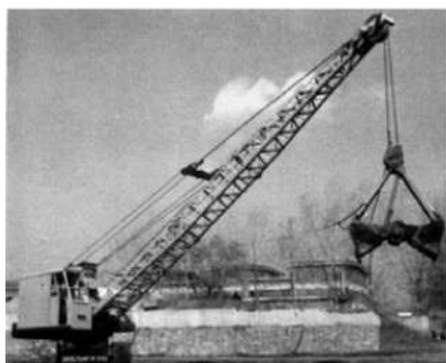
(a) 抓铲挖土机外形图
