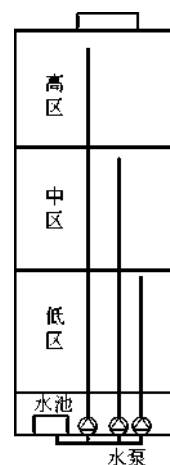
图 2-14 变频调速水泵给水方式
