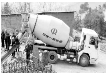
图 3-20 混凝土搅拌运输车
