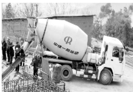
图 3-20 混凝土搅拌运输车
