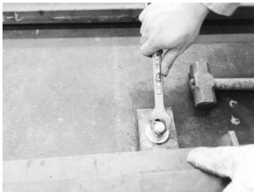
图 3-20 螺栓销钉固定
