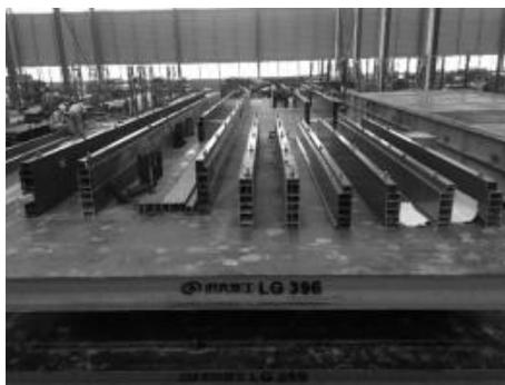
图 3-5 梁模具安装
