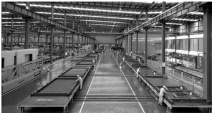
图 1-19 PC 构件的工业化生产流水线
