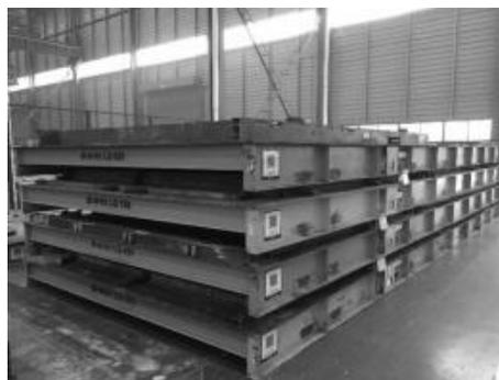
图 3-6 墙板模具安装
