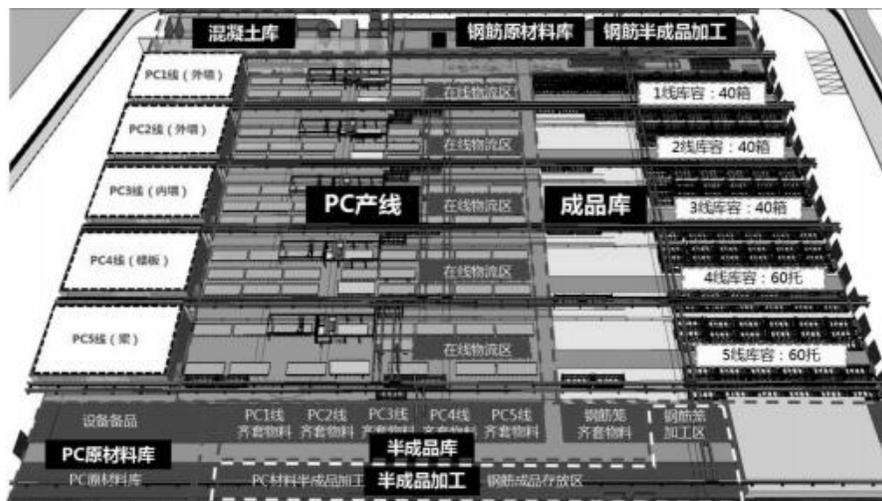
图 3-77 齐套配送车间整体布局图
