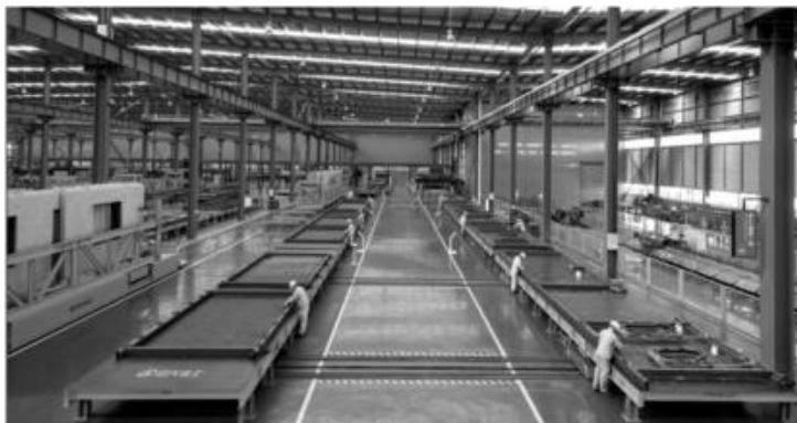
图 1-19 PC 构件的工业化生产流水线
