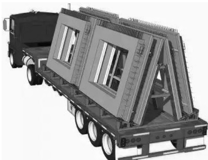
图 2-1 墙板“人”字架式(斜卧式)运输车
