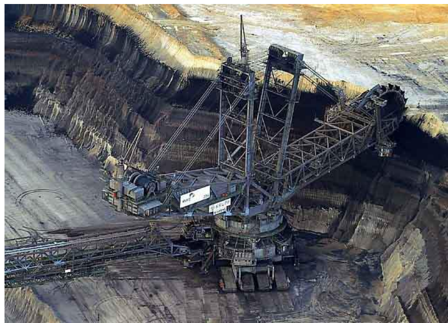
多轮斗式挖掘机进行冻土开挖
