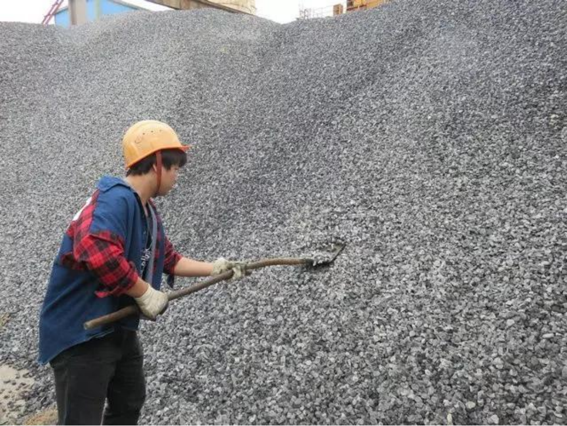
▲ 构件厂材料取样检测
