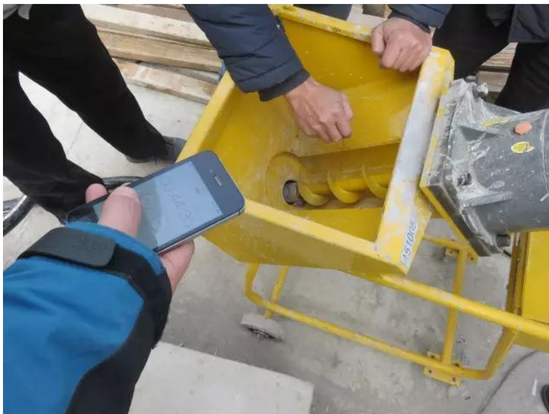
▲ 灌浆机械转速测试
