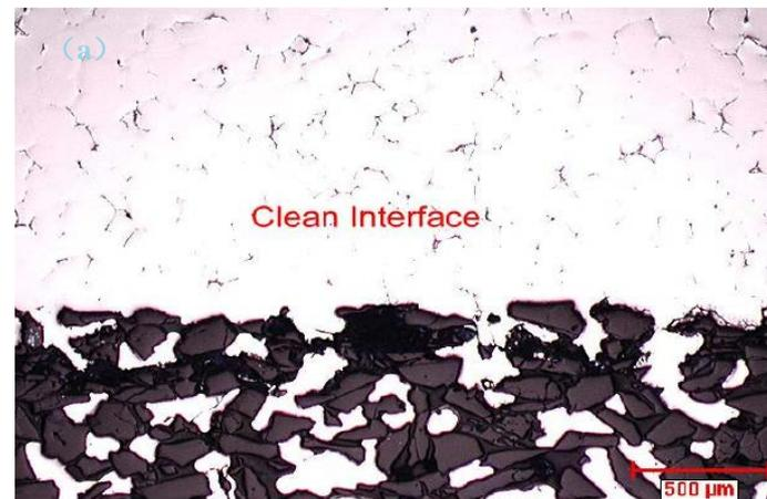
采用优化后的保温炉和在线净化工艺得到的熔体中的杂质总含量仅为0.016 mm<sup>2</sup>/kg，达到了客户的要求，且其中对表面质量影响较大的硬质MgO和尖晶石状MgAl<sub>2</sub>O<sub>4</sub>的含量接近0。
