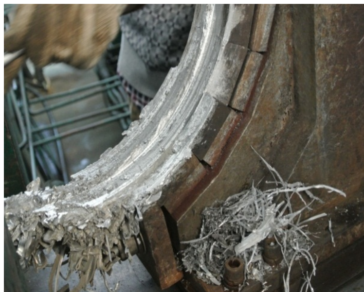
图5 大量坯料粘着于靴体——“积料” ( V=3\sim 3.5\text{ rpm} )
