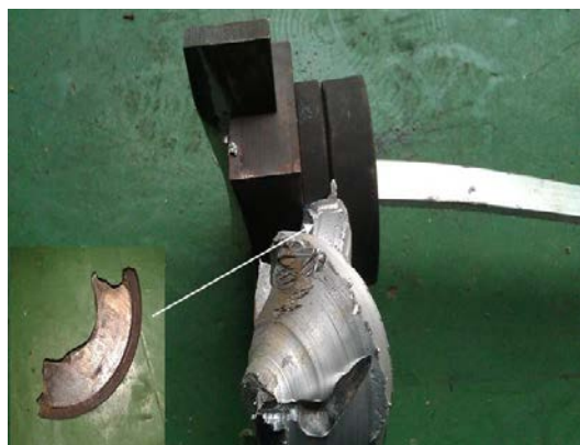
图12 挤压模具的破坏性损伤
