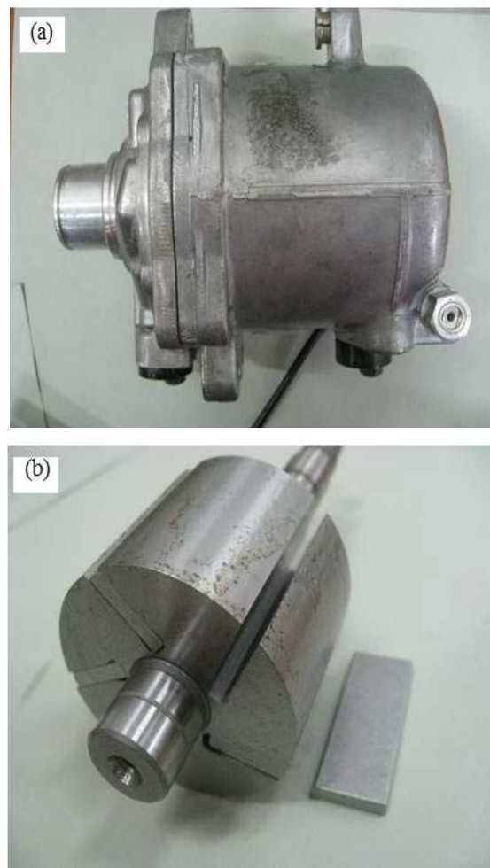
图1 应用滑片式空气压缩机及其滑片 (a) 滑片式空气压缩; (b) 滑片
