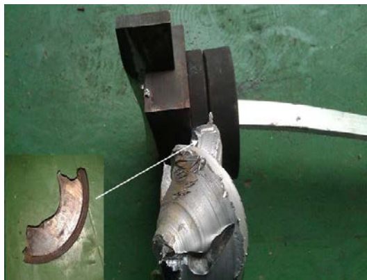
图12 挤压模具的破坏性损伤
