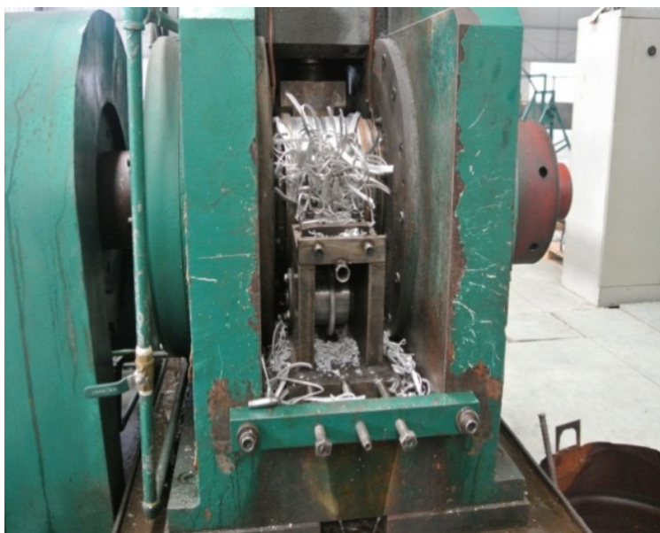
图4 “跑料”现象 ( V=3\sim 3.5\text{ rpm} )
