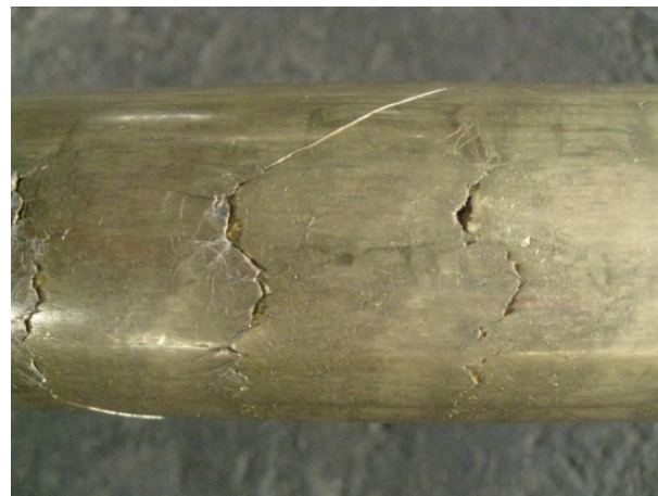
图3 H65黄铜管在冷轧过程中因工艺控制不当而引起的缺陷
