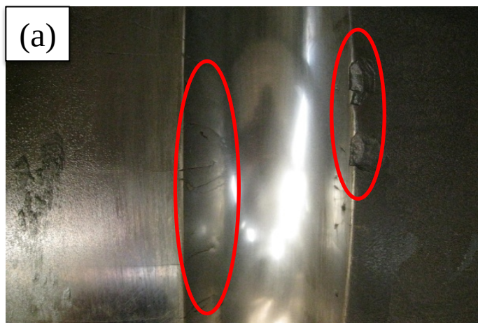
图13 孔型磨损较为严重的轧辊照片
