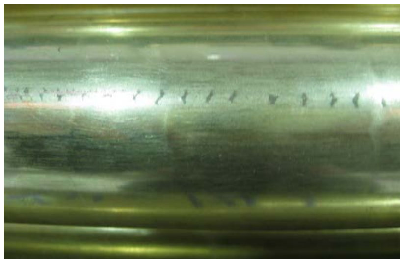
图11 冷轧时因送进量过大引起的表面 环形压痕
