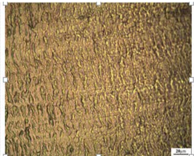
图7 正常铜箔表面形貌
