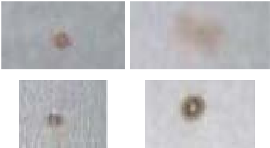
图9 黄点缺陷宏观形貌
