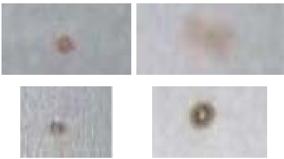
图9 黄点缺陷宏观形貌
