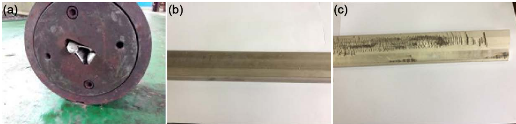
图12 不同挤压温度的型材实物图 (a) 350℃；(b) 380℃；(c) 400℃
