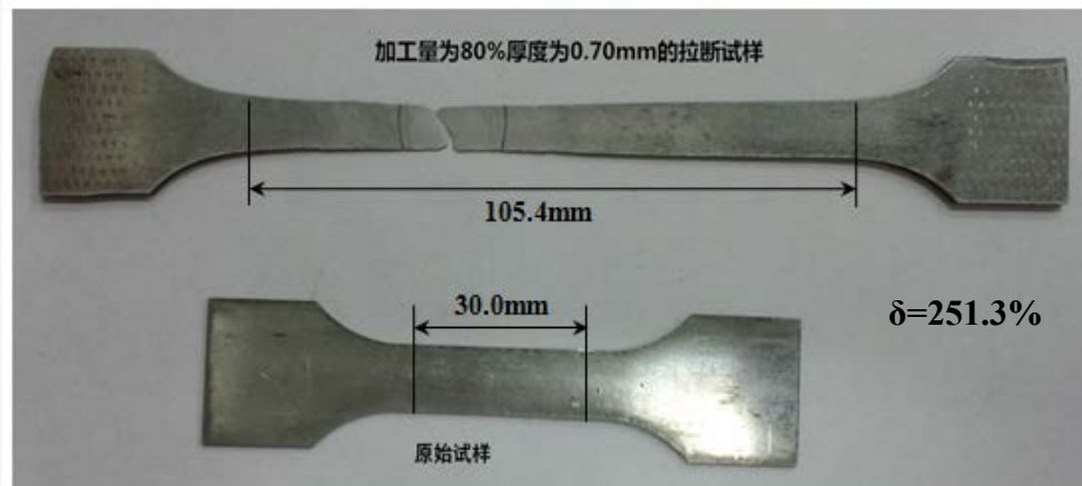
图2 稀土Zn-Cu-Ti合金试样（变形率80%； 厚度0.70 mm）拉伸前后对比
