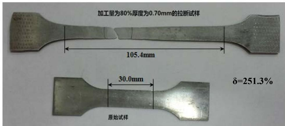
图2 稀土Zn-Cu-Ti合金试样（变形率80%；
