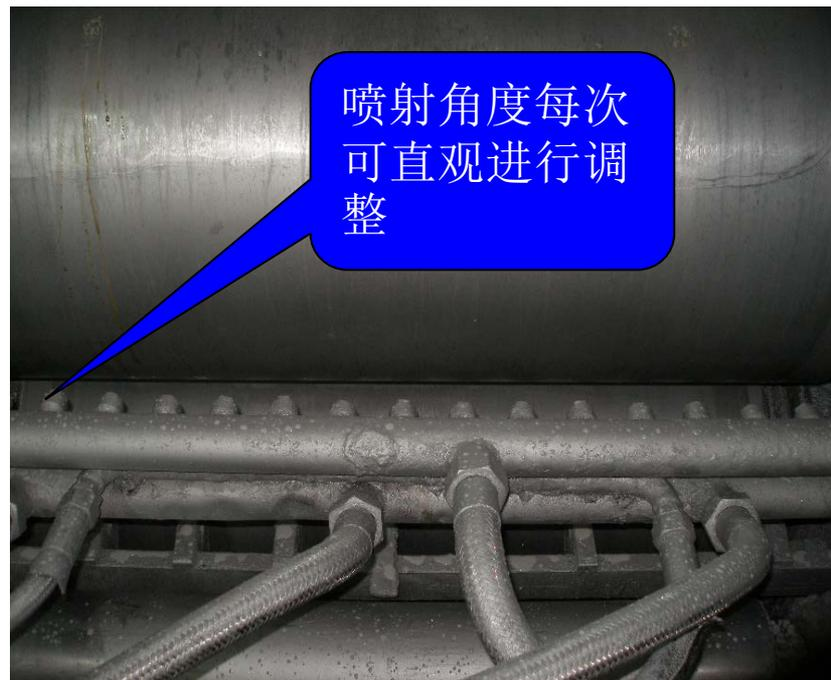
图4 热轧机上辊乳液喷射集管
