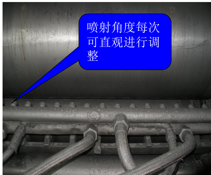
图4 热轧机上辊乳液喷射集管
