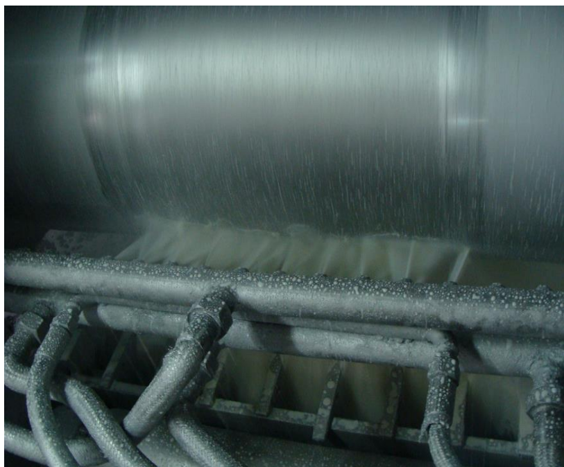
图4 热轧机上辊乳液喷射集管
