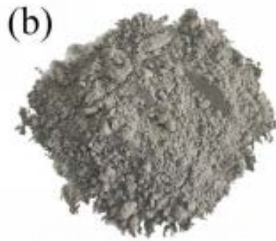
图9 二次铝灰焙烧前后的像：(a) 焙烧前 (b) 焙烧后
