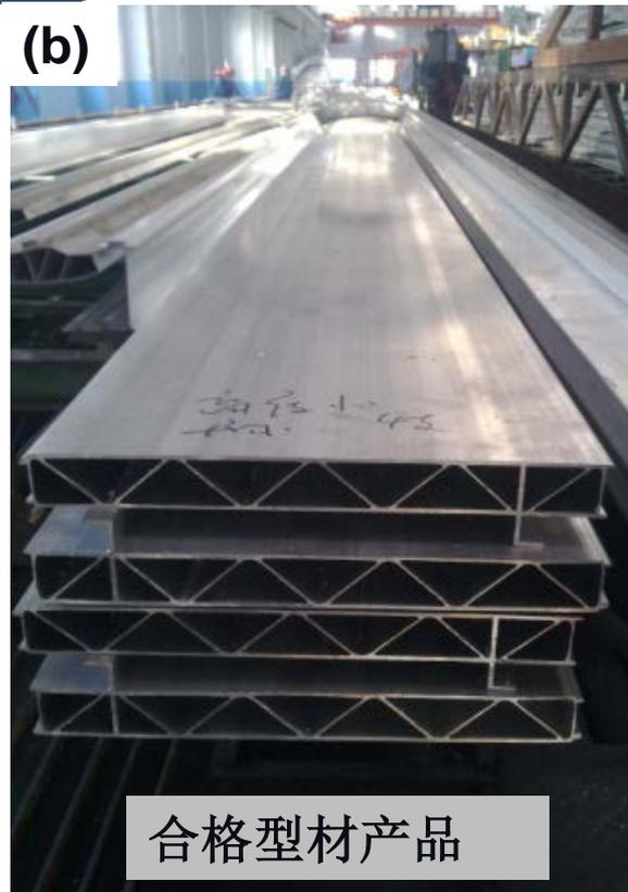
修模完成的模具装配好后再次上机挤压，**第三次试模**挤出的铝合金型材表面光滑明亮，没有擦伤、划伤和明显的挤压纹路，型材各处平面度、弯曲度、扭曲度及断面尺寸均满足要求，试模成功后的模具后续生产成功挤料**58吨**。
