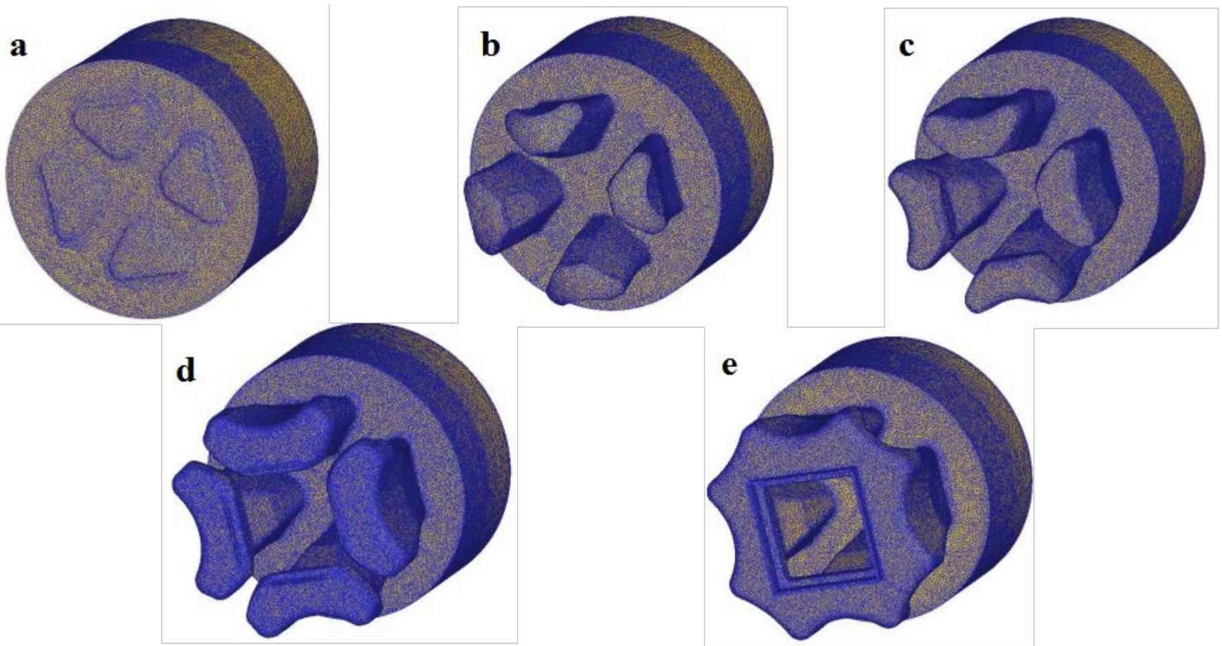
a 镢粗； b 分流； c 填充分流孔间隙； d 焊接； e 稳态挤压
