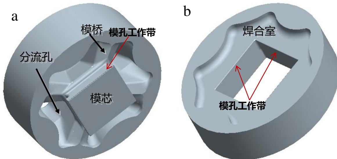
图1 方管型材分流模结构示意图
