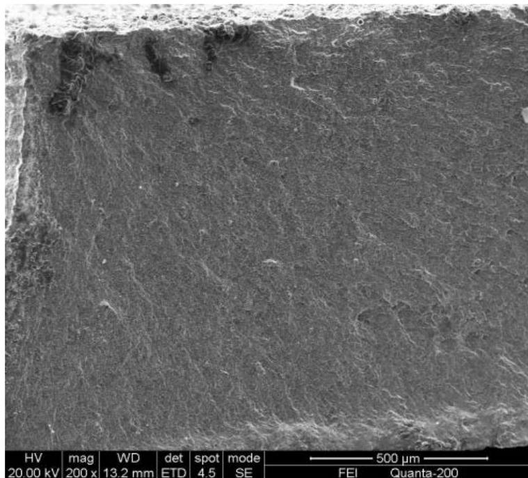
由实验结果的分析可知，H13钢的疲劳裂纹源都处于试样的棱角处，没有发生于试样内部的裂纹源，在表面裂纹源处也未见第二相及夹杂物。实验结果证明，H13钢的纯净度较高，在正常状态下不会出现粗大第二相和夹杂物；该试样在圆弧处，存在明显的应力集中现象。据此推断，裂纹源起源于试样侧表面的应力集中部位。如果表面存在粗大夹杂物或脆性相，则更容易引起应力集中和疲劳开裂。
