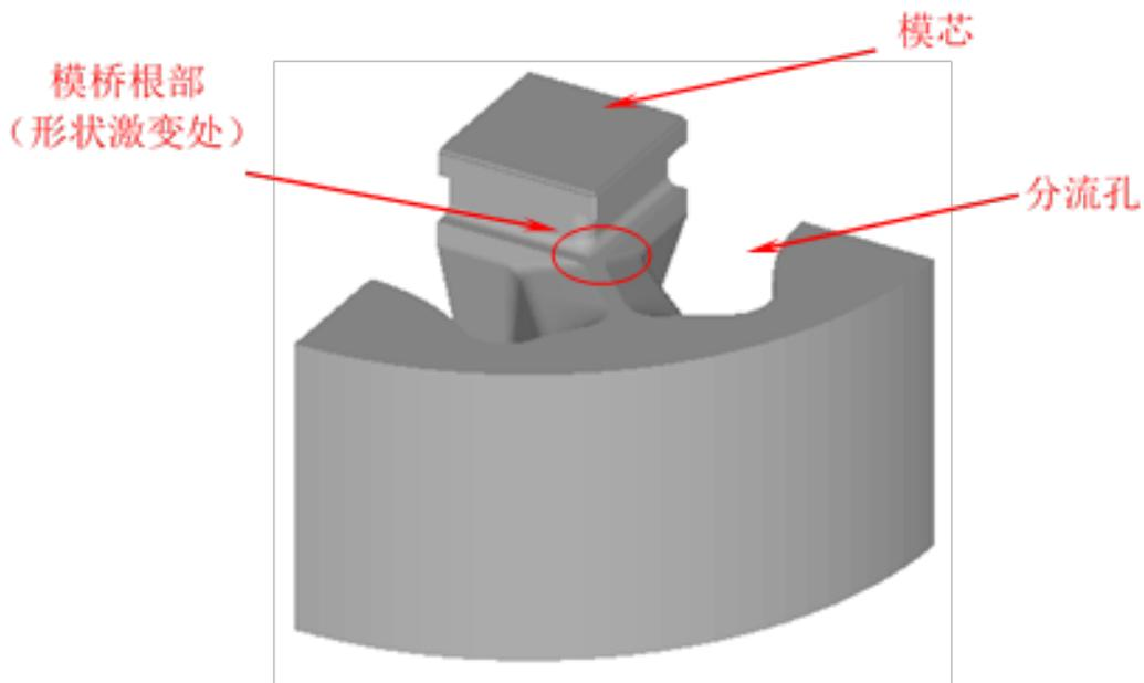
图8 分流组合模上模示意图 (1/4)
