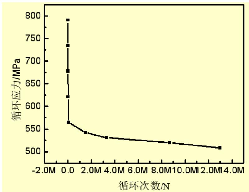
模具的实际服役温度约为**500°C**。取 $\sigma_b=1129.3\text{MPa}$ ，按照疲劳实验的要求，依次选取500°C下 $0.7\sigma_b$ 、 $0.65\sigma_b$ 、 $0.6\sigma_b$ 、 $0.5\sigma_b$ 、 $0.45\sigma_b$ 五个应力加载水平。采用单点测试法，并对实验数据采用曲线拟和绘出H13钢的应力幅与断裂循环次数的关系曲线，即获得H13钢的S-N曲线。对于基数为 $10^7$ 的疲劳循环次数，H13钢的疲劳极限为 $\sigma_{-1P}=\mathbf{508\text{ MPa}}$ 。
