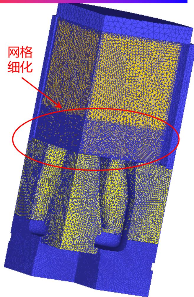
图3 模具和坯料的有限元模型
