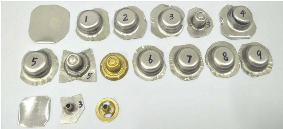
图15 不同状态铝带片状样双针底座连续拉深实物图
