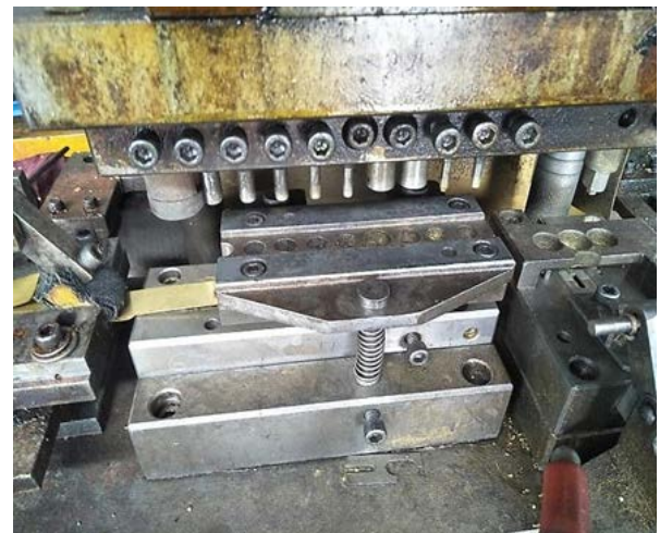
图5 连续拉深设备
