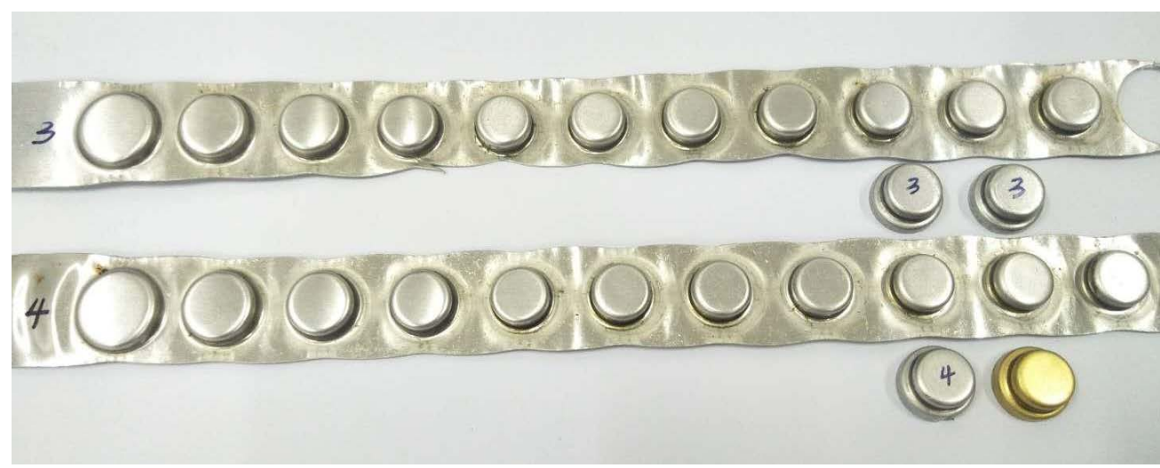
图16 3#、4#铝带钮面连续拉深试验实物图
