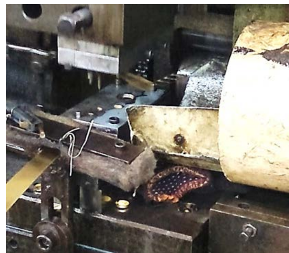
图4 钮面冲裁设备
