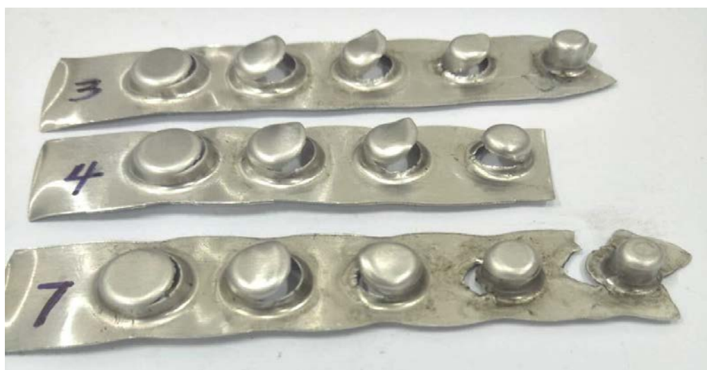
图14 3#、4#、7#铝带开窗底连续拉深 ( h 小) 试验实物图
