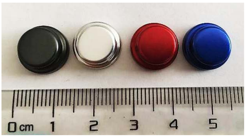
图17 铝制钮面阳极氧化着色效果图
