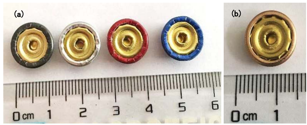
图18 铝制钮面组装实物图 (a) 黑、银、红、蓝色组装效果； (b) 边缘掉色
