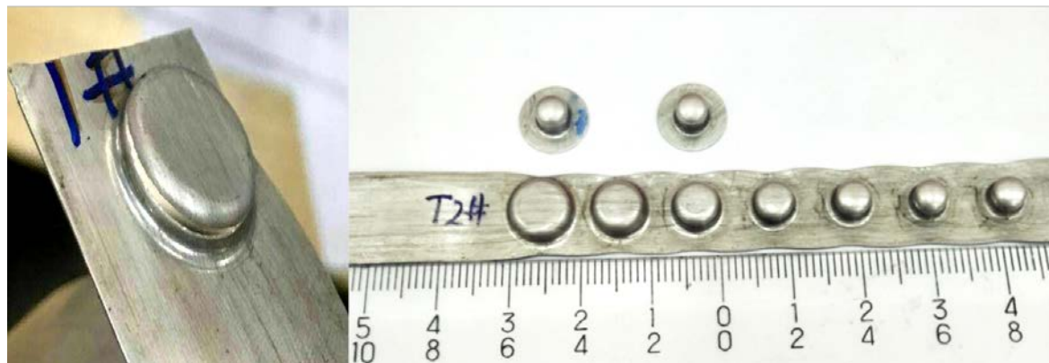
图8 1#、2#合金退火态带材钮珠连续拉深 (a) 1#退火态 (拉裂)； (b) 2#退火态
