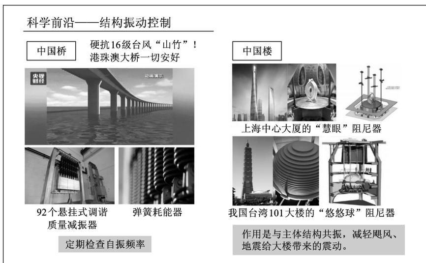
图 2.55 结构振动控制的工程应用实例
