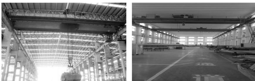
图 3.73 工业厂房中的吊车荷载
