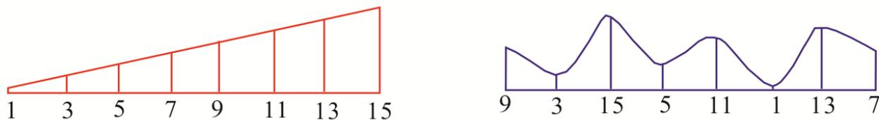
图5-12 变化系数相同而变化程度不同的两组厚度变化示意图
