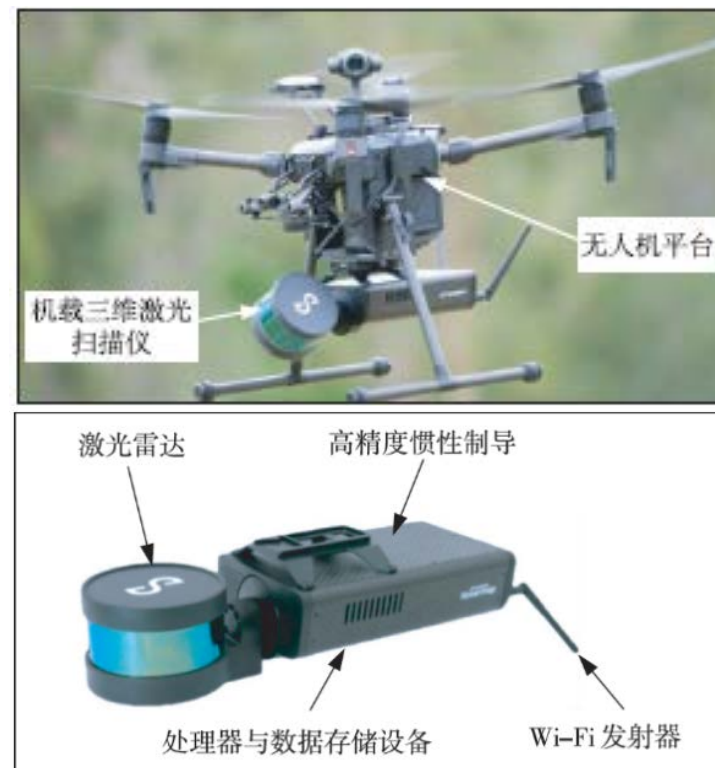
无人机三维激光探测系统及其作业原理
